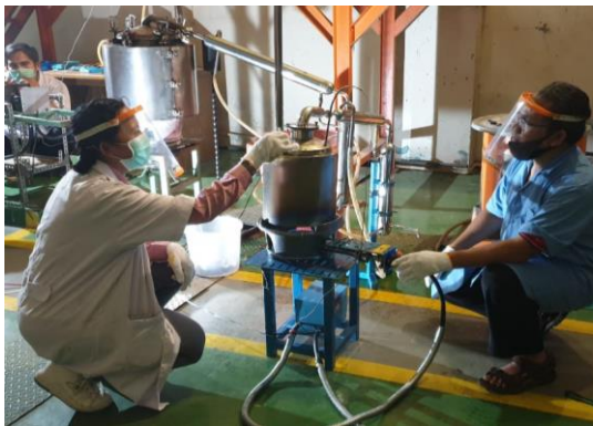
Gambar 1. Alat Modifikasi Pirolisis (sumber: Dokumen Pribadi)
