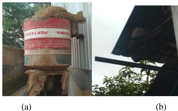
Gambar 3. Modifikasi Alat Mesin Pengering Vertical Dryer untuk Meminimalisir Cemaran Lingkungan (a) Drum tampungan berambut dan kotoran hasil pengeringan; (b) Tambah cerobong untuk membuang abu hasil pembakaran
